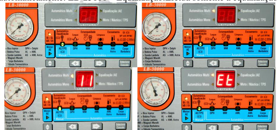
Obs. Caso a pressão esteja diferente da tabela ajustar através dos botões +/- para a pressão adequada (pré-ajuste 3 bar).
